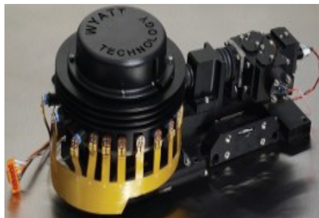
شکل ۹: نمای داخلی دتکتورها
