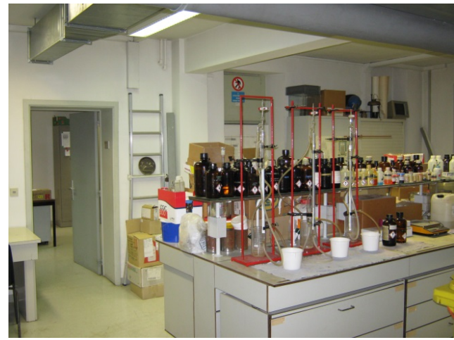
شکل ۲: نگهداری بیش از مقدار مورد نیاز مواد شیمیایی بر روی میز آزمایشگاه
