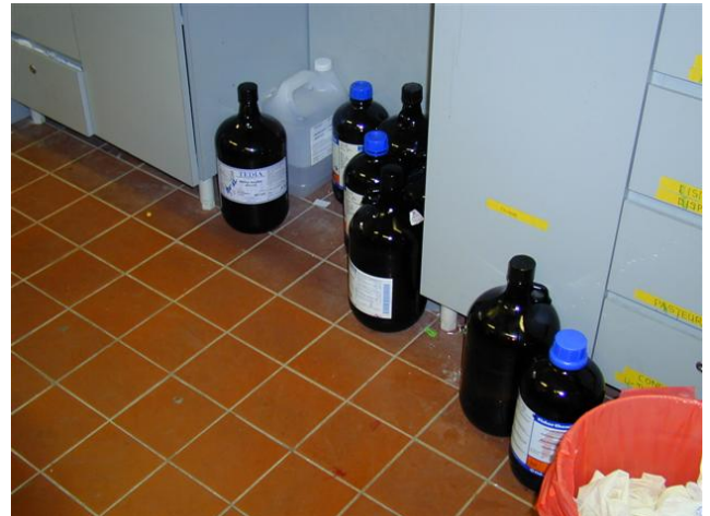
شکل ۴: یک نمونه از نگهداری نامناسب مواد شیمیایی
